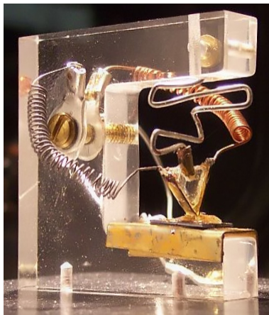
Nachbau des ersten Transistors (Bell Labs 1947) 3
